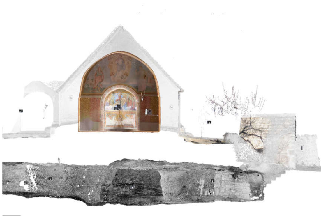
Figura 26. Modello tridimensionale dell'ipogeo di Mangiato. Si osserva la sovrapposizione tra gli ambienti interrati e fuori-terra. Lo strato di roccia mediamente alto un metro e ottanta separa e sospende la cappella rispetto l'ipogeo sottostante.
