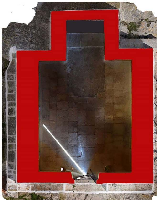
Figura 9. Nella figura appare evidenziata la porzione di muro sezionata in rosso, in cui emerge una differenziazione di spessori murari. Immagine tratta dal rilievo fotogrammetrico.
