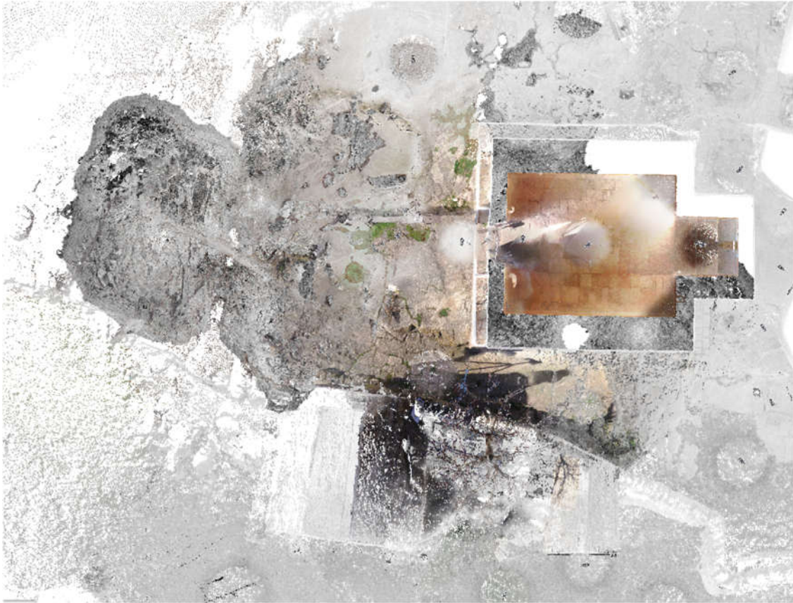
Figura 24. Pianta della nuvola tridimensionale in cui convivono sia l'ipogeo sottostante che la chiesa del Mangiato.
